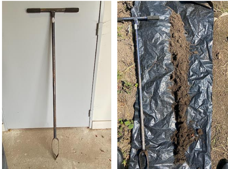
Fig. 14 : Photographie d'une tarière à gauche et carotte de sol prélevée à droite.
