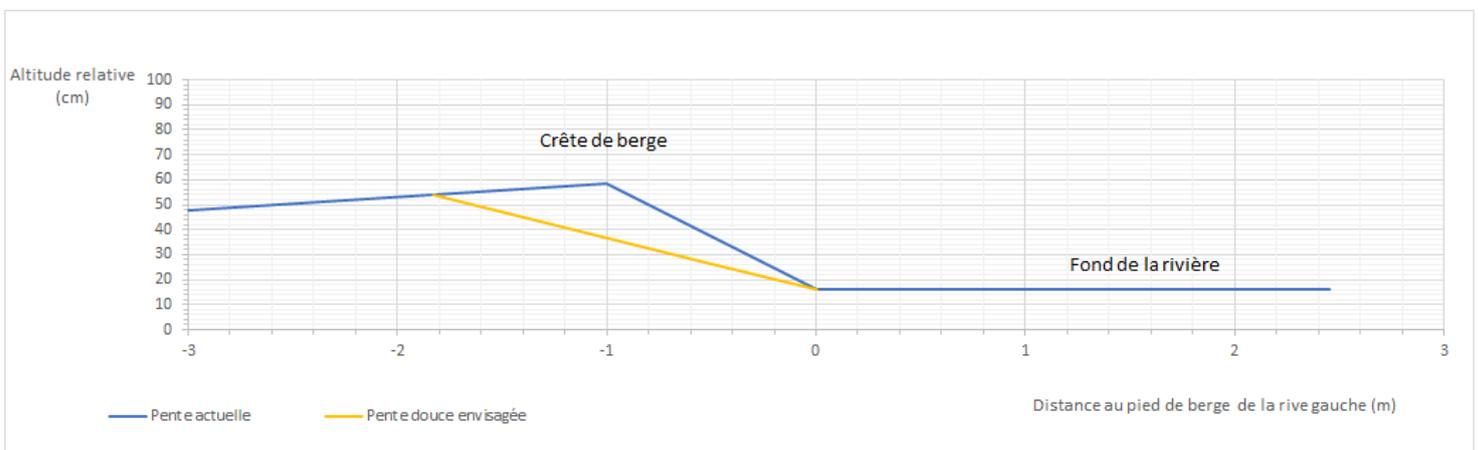
Fig.11 : Profil topographique moyenné du Tourterou aval rive gauche réalisé avec le logiciel Excel. Ce cours d'eau étant étroit avec peu de débit, un remblai n'est pas nécessaire, le terrassement commence directement au pied de berge.
