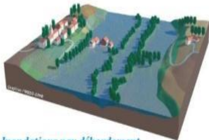
Inondations par débordement
