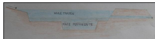
Figure 10 : Coupe transversale d'une mare tampon (source : Cyril LAMARRE)
